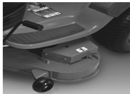
Coque d'unité de coupe estampée ci-dessous, NON renforcée
