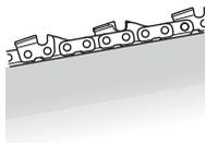
**Zorg ervoor dat de tanden van de ketting goed en juist geslepen zijn! Volg onze instructies en gebruik de aanbevolen vijlmal.** Een verkeerd geslepen of beschadigde ketting verhoogt het risico op ongevallen.
