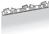
**Veiller à ce que les dents de la chaîne soient toujours bien affûtées! Suivre les instructions et utiliser le gabarit d'affûtage recommandé.** Une chaîne émoussée ou endommagée augmente le risque d'accidents.
