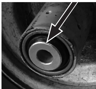
SEPARADOR DEL EJE INSTALADO
