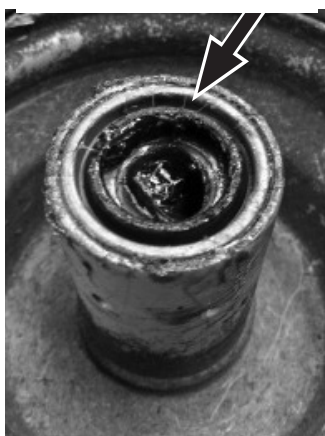
NUEVA JUNTA INSTALADA
