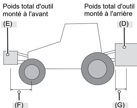
Distance : Centre de gravité d'outil attelé à l'avant jusqu'au milieu de l'essieu avant
