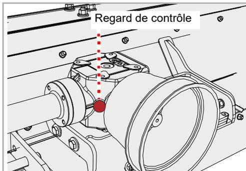
L'huile pour transmission doit être conforme à la spécification.
