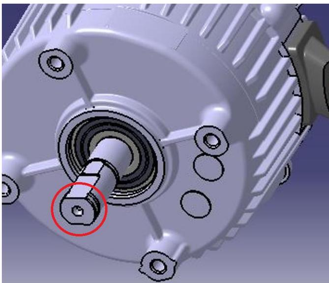
Nouveau **SYSTÈME DE COUPE 529 53 71-01** > (l'arbre du moteur comprend un trou de vis, voir ci-dessous) compatible **UNIQUEMENT** avec le RESSORT DE DISQUE 597 67 01-01, la RONDELLE 503 23 00-35 et la VIS 503 21 53-20. Ce nouveau système de coupe inclut le MOTEUR 529 65 38-01.
